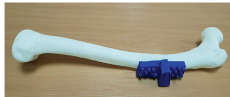
Рисунок 4 Зовнішній вигляд навігатора, фіксованого до прототипу стегнової кістки
